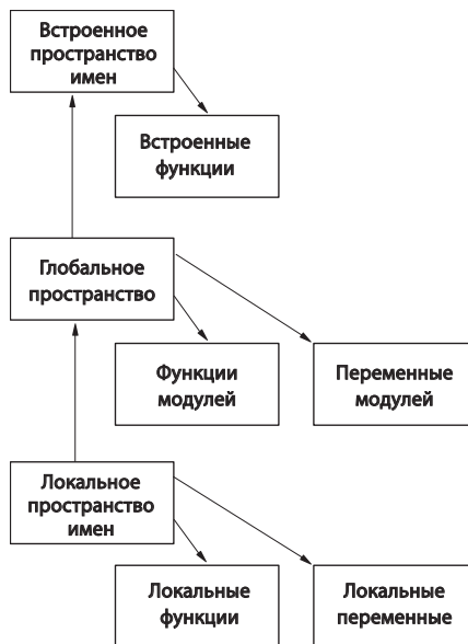
Рис. 10.2. Порядок проверки пространств имен при поиске идентификаторов
